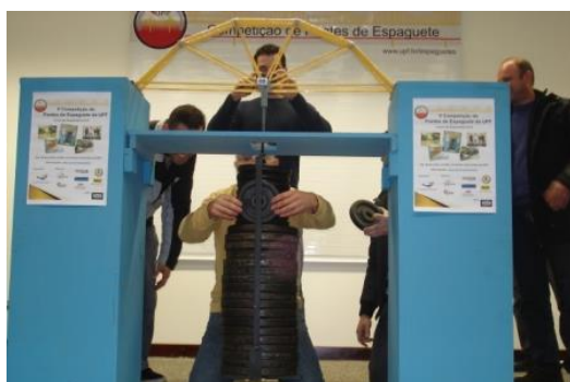
Figura 01: Ensaio destrutivo da ponte vencedora da 5ª Competição de Pontes de Espaguete do Curso de Engenharia Civil da Universidade.
