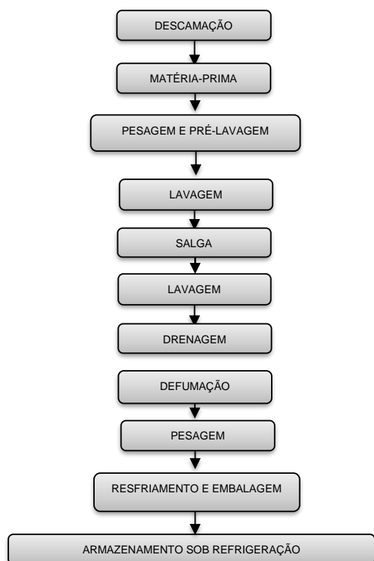
Figura 1. Fluxograma do processamento de pescado defumado e refrigerado
